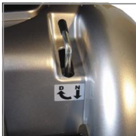
Håndtag for aktivering/deaktivering af manuel drift
