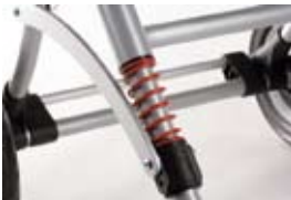
Fodbremse med hel strang. Patentanmeldt affjedring.
